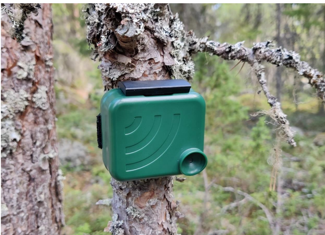
Kuva 9. AudioMoth on ohjelmoitava sisäisellä mikrofonilla varustettu ultraäänitallennin. (TK).
