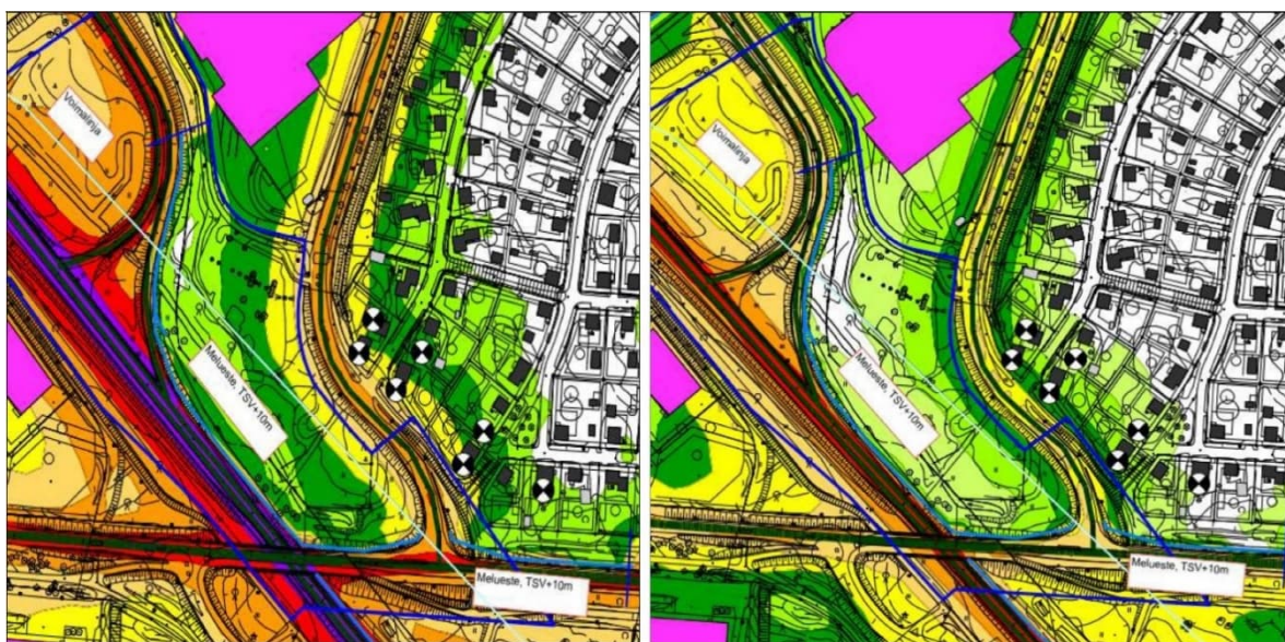
Kuvissa 10 metriä korkeat meluntorjuntaseinät. Vasemmalla on päivätilanne ja yö on oikealla.
