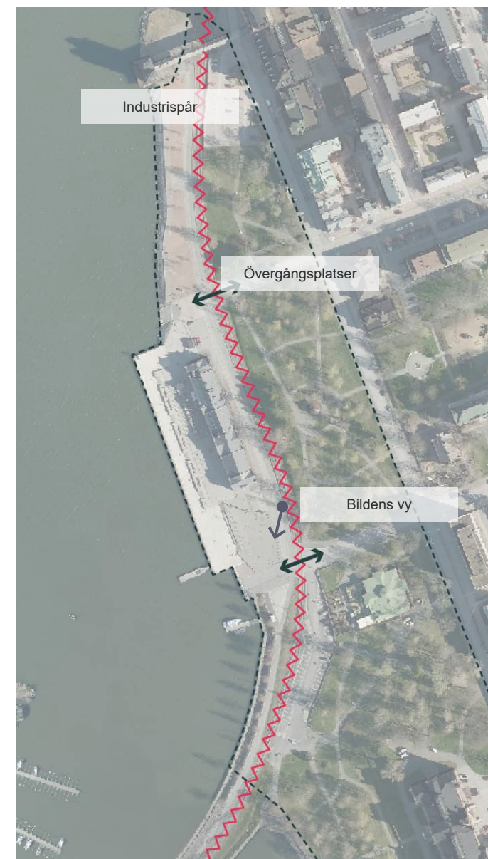
Illustration av en expanderad järnvägsförbindelse för persontrafik. Källa: Vaasan raideliikenteen tarve- ja toteuttamiskelpoisselvitys 1.3.2023, Ramboll Finland Oy
