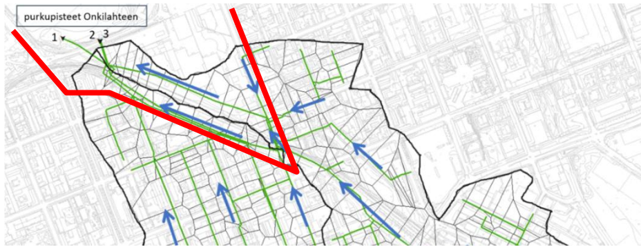
Hulevesiverkosto vihreällä. Veden virtaussuunta sinisellä. Purkupisteet on numeroitu kuvan ylälaitaan. Asemakaavarajaus osoitettu karkeasti punaisella.
