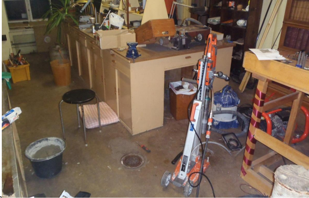
Kuva 37. Näyte PS6. Välipohja. Näyte ~100 mm yläpinnasta (ruskea maali + tasoite 20 mm + betoni ~80 mm), näyte katkaistu. Välipohjarakenne näytteenottokohdassa ei selvinnyt porauksen päätyttyä. Näytteestä ei analysoitu merkittävästi kohonneita haitta-ainepitoisuuksia.
