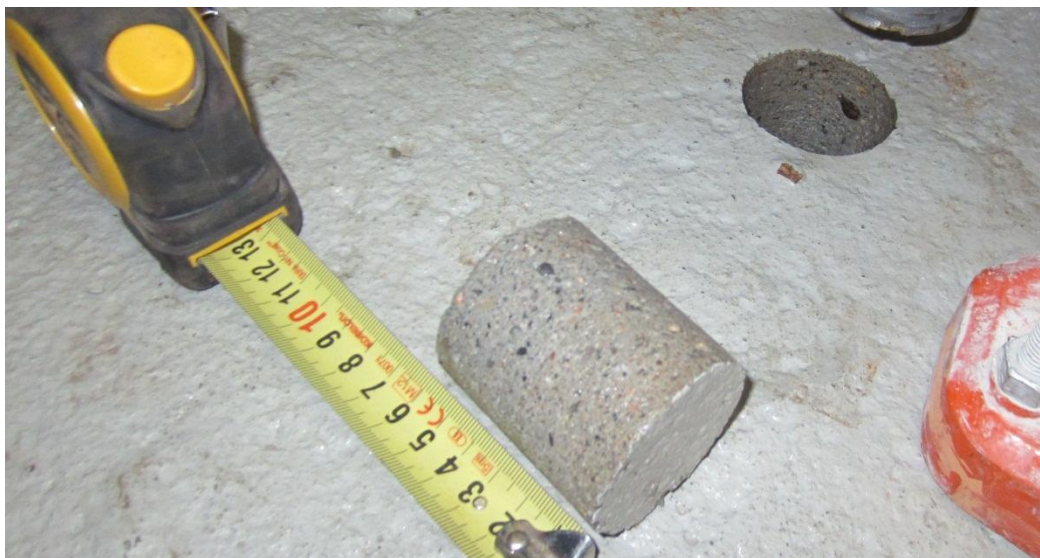
Kuva 25. Näyte PR14. Välipohja. Näyte ~60 mm yläpinnasta (harmaa maali + betoni ~60 mm), näyte katkaistu. Välipohjarakenne näytteenottokohdassa ei selvinnyt porauksen päätyttyä. Näyte sisältää öljyhiilivetyjä C 10 -C 40 1400 mg/kg.
