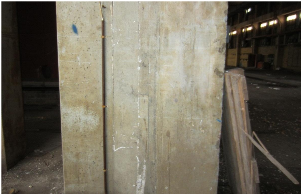
Kuva 8 Mittauspiste MX2. Kannettavalla röntgenfluoresenssispektrometrillä saatujen tulosten perusteella pilarin pinnassa ei ole merkittävästi kohonneita pitoisuuksia raskasmetalleja. Mittauskorkeus noin 1200 mm lattiatason yläpuolella.
