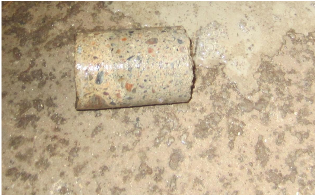
Kuva 3. Näyte PM3. Alapohja. Näyte ~70 mm pinnasta (betoni), näyte katkaistu. Alapohjarakenne näytteenottokohdassa ei selvinnyt porauksen päättyessä suureen teräkseen. Näyte sisältää öljyhiilivetyjä C 10 -C 40 760 mg/kg.
