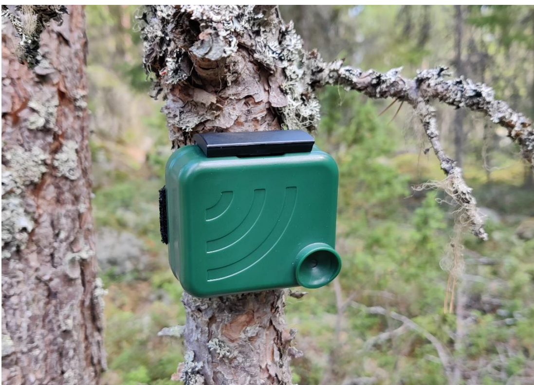
Kuva 8. AudioMoth on ohjelmoitava sisäisellä mikrofonilla varustettu ultraäänitallennin.
