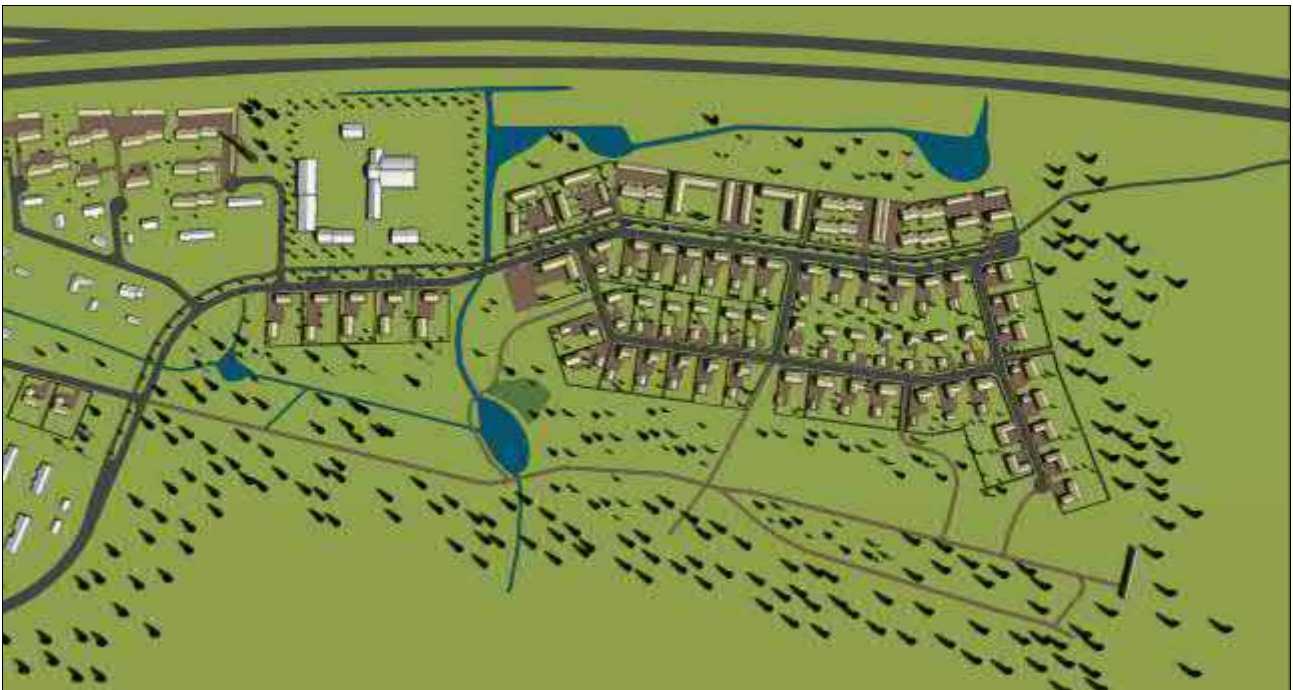
Kuva 5. Havainnekuva Vanhan sataman eteläosasta. Kuva osoittaa hulevesien hallinnan pääperiaatteet. Leikkipaikka on kuvattu alueen keskivaiheille tummanvihreällä. Oikeassa alareunassa on vanha ampumarata-alue.
