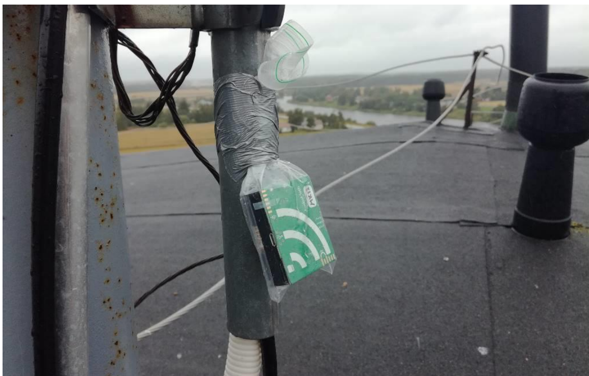
Kuva 6. AudioMoth on ohjelmoitava sisäisellä mikrofonilla varustettu ultraäänitallennin.
