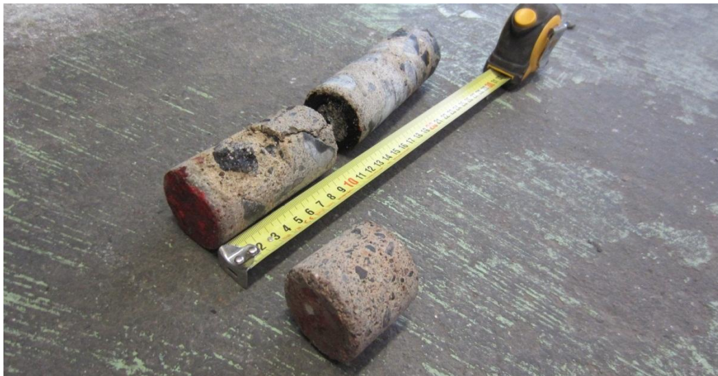
Kuva 28. Näyte PR17. Alapohja. Näyte ~100 mm vanhan betonilaatan pinnasta (punainen maali + betoni ~100 mm), näyte katkaistu (ylemmästä osasta näyte PR16). Alapohjarakenne näytteenottokohdassa ylhäältäpäin lueteltuna on harmaa maali + betoni ~50 mm + punainen maali + betoni ~100 mm + kosteudensulkusively + betoni ~140 mm + sora. Näytteestä ei analysoitu merkittävästi kohonneita haitta-ainepitoisuuksia
