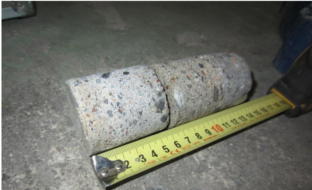
Kuva 29. Näyte PR18. Alapohja. Näyte ~140 mm pinnasta (harmaa maali + betoni ~60 mm + betoni ~80 mm), näyte katkaistu. Alapohjarakenne näytteenottokohdassa ei selvinnyt porauksen päätyttyä. Näytteestä ei analysoitu merkittävästi kohonneita haitta-ainepitoisuuksia.
