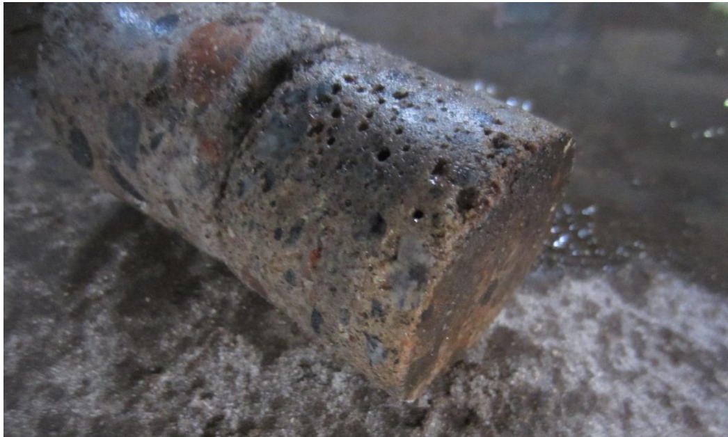
Kuva 1. Näyte PM1. Alapohja. Näyte ~70 mm pinnasta (betoni), näyte katkaistu. Alapohjarakenne näytteenottokohdassa ylhäältäpäin lueteltuna on betoni ~70 mm + betoni ~100 mm + sora. Näyte sisältää öljyhilivetyjä C 10 -C 40 5900 mg/kg.
