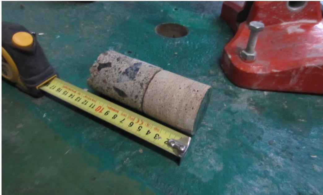
Kuva 13. Näyte PR2. Välipohja. Näyte 115 mm yläpinnasta (tumman vihreä maali + tasoite ~55 mm + betoni ~60 mm), näyte katkaistu. Välipohjarakenne näytteenottokohdassa ei selvinnyt porauksen päätyttyä. Näyte sisältää öljyhiilivetyjä C_{10} - C_{40} 1500 mg/kg.
