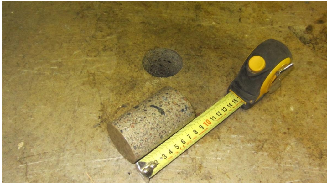
Kuva 15. Näyte PR4. Alapohja. Näyte ~85 mm pinnasta (ruskea maali + betoni), näyte katkaistu. Alapohjarakenne näytteenottokohdassa ei selvinnyt porauksen päätyttyä. Näyte sisältää öljyhiilivetyjä C 10 -C 40 640 mg/kg.
