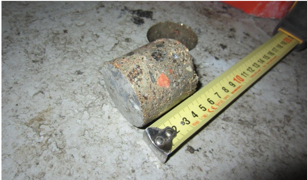
Kuva 19. Näyte PR8. Välipohja. Näyte ~50 mm yläpinnasta (harmaa maali + betoni ~50 mm), näyte katkaistu. Välipohjarakenne näytteenotokohdassa ei selvinnyt porauksen päätyttyä. Näyte sisältää öljyhiilivetyjä C 10 -C 40 14000 mg/kg. Vaarallisen jätteen raja-arvo ylittyy.
