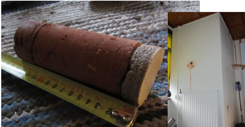
Kuva 23a ja b. Näyte PR12. Savuhormi. Näyte ~140 mm pinnasta (valkoinen maali + tasoite ~10 mm + tiili ~130 mm), näyte katkaistu. Näytteestä ei analysoitu merkittävästi kohonneita haitta-ainepitoisuuksia.
